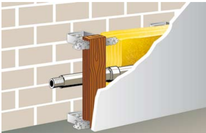
Problemloses Verkleiden von Rohren und Leitungen.
